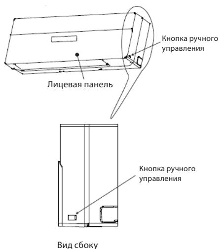
**ПРИМЕЧАНИЕ:** Перед переходом на ручное управление кондиционер необходимо выключить. Если кондиционер работает, следует нажать кнопку ручного управления и удерживать ее до выключения прибора.
