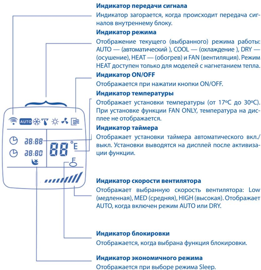
⚠ **Примечание:** Все показанные на рисунке символы продемонстрированы одновременно для большей наглядности. Однако при использовании пульта дистанционного управления на дисплее будут отображаться только символы используемых функций.
