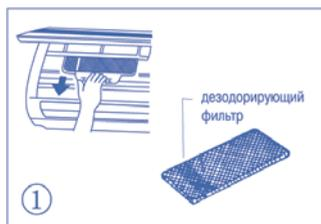
4. Извлеките дезодорирующий фильтр из рамки. Способ извлечения и установки фильтра зависит от модели кондиционера (см. рис. 1 и 2 слева).
