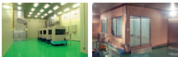
Климатическая камера для испытания оборудования при различных температурных условиях работы
