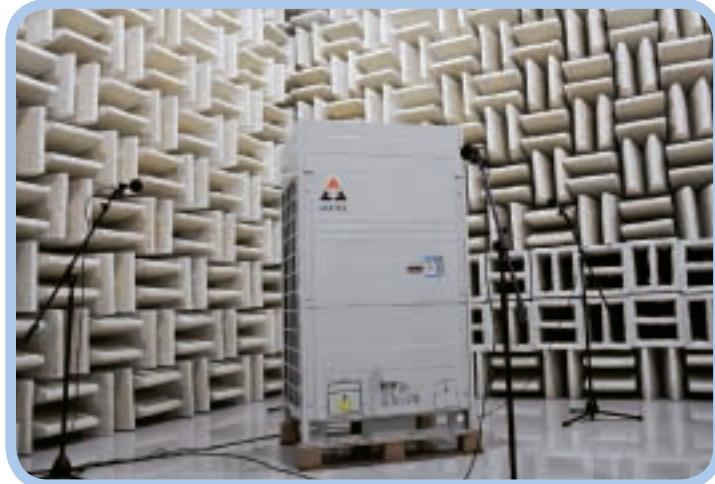
Тестовый центр – это масштабная мультифункциональная лаборатория, основная задача которой – изучение вопросов эксплуатации бытовых и коммерческих кондиционеров, вопросов безопасности, эксплуатационной надежности и проведение сертификационных исследований. Площадь центра – 6000 кв. метров.
