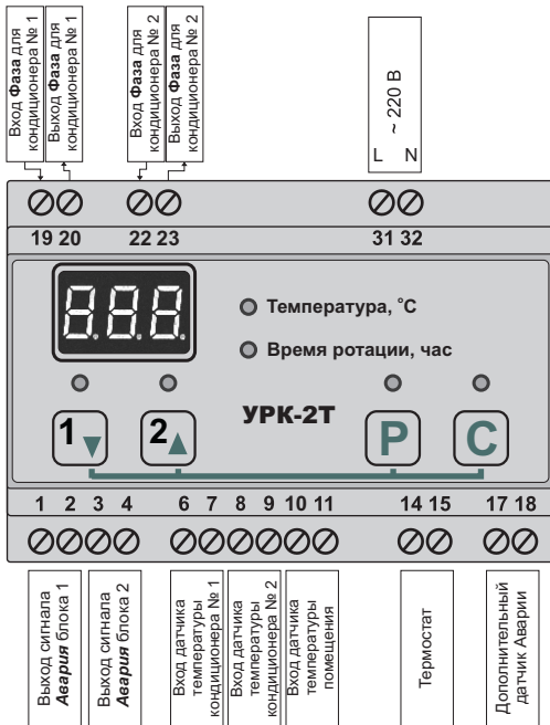
Рис.2 Схема подключения.
