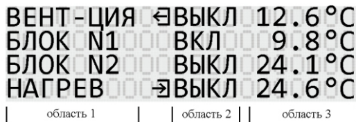
Рисунок 3 - Пример индикации в рабочем режиме
