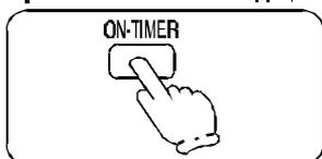
При нажатии кнопка ON-TIMER высвечивается в мигающем режиме.
