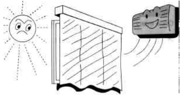
■ Правильно регулируйте направление воздушного потока. В режиме охлаждения установите жалюзи горизонтально. В таком положении результат охлаждения будет лучше.
