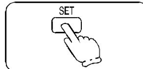
Загорается контрольная лампочка таймера на основном блоке - оранжевая
