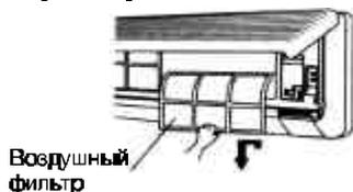
**2** Снимите фильтрующий элемент воздухоочистителя.
