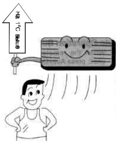
Регулярно очищайте воздушный фильтр. Засорение этого фильтра приводит к уменьшению мощности воздушного потока и снижению эффективности охлаждения. Очистку фильтра следует производить по меньшей мере один раз в две недели. В противном случае возрастает потребление электроэнергии примерно на 6%.
