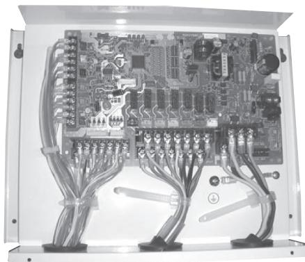
Контроллер PAC-IF011B-E предназначен для организации взаимодействия компрессорно-конденсаторных блоков<sup>1</sup> (ККБ) с приточными установками и центральными кондиционерами. Контроллер обеспечивает плавное (ступенчатое) регулирование производительности ККБ по внешнему аналоговому или цифровому сигналу. Предусмотрен режим автоматического выбора шага производительности для автономного регулирования (требуется пульт управления PAR-21MAA).
