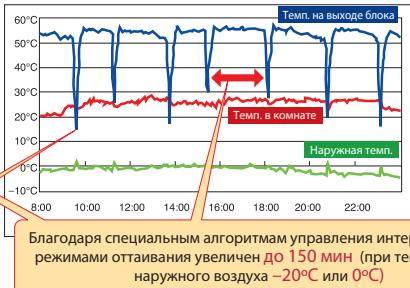
Благодаря специальным алгоритмам управления интервал между режимами оттаивания увеличен до 150 мин (при температуре наружного воздуха  $-20^{\circ}\text{C}$  или  $0^{\circ}\text{C}$ )
