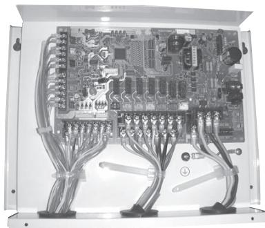
Контроллер PAC-IF031B-E предназначен для управления тепловыми насосами «воздух–вода» полупромышленной серии Mr. Slim, а также исполнительными устройствами контура теплоносителя: циркуляционным насосом, 3-ходовым клапаном, двухсекционным электрокотлом, электронагревателем бойлера.
