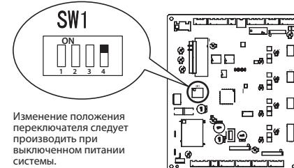
Изменение положения переключателя следует производить при выключенном питании системы.
