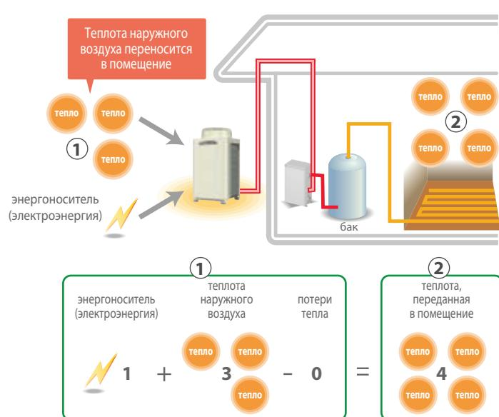
электрической энергии, «перекачивает» в помещение от 2 до 6 единиц тепловой энергии, забирая ее из наружного воздуха. Поэтому высокая эффективность воздушного теплового насоса делает естественный выбор в пользу таких систем для отопления помещений и нагрева воды на объектах, имеющих ограниченные энергоресурсы.
