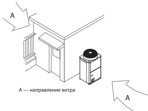
б) Выбирайте место для установки наружного блока, расположите его так, чтобы ветер преимущественного направления не воздействовал на теплообменник: расположите блок передней панелью к направлению ветра.
