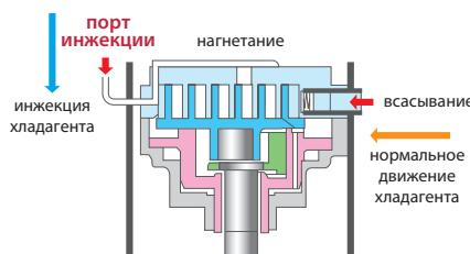
Инжекция жидкого хладагента создает существенную нагрузку на компрессор, снижая его энергетическую эффективность. Для уменьшения этой нагрузки введен теплообменник HIC. Передача теплоты между потоками хладагента с разными значениями давления приводит к тому, что часть жидкости испаряется. Образовавшаяся парожидкостная смесь при инжекции в компрессор создает меньшую дополнительную нагрузку.
