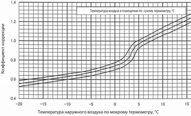
Коррекция потребляемой мощности в режиме нагрева
