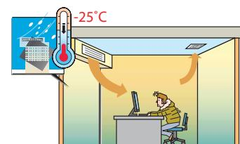
Производительность обычных кондиционеров снижается почти вдвое при низкой наружной температуре.
