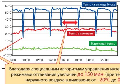
Пример эксплуатации наружного блока
