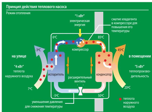
$$\begin{array}{rcl} & & "1 \text{ кВт}" \\ & + & \text{потребляемая электрическая мощность} \\ & & \\ & & "4 \text{ кВт}" \\ & = & \text{теплота наружного воздуха} \\ & & \\ & & "5 \text{ кВт}" \\ & & \text{теплопроизводительность} \end{array}$$
