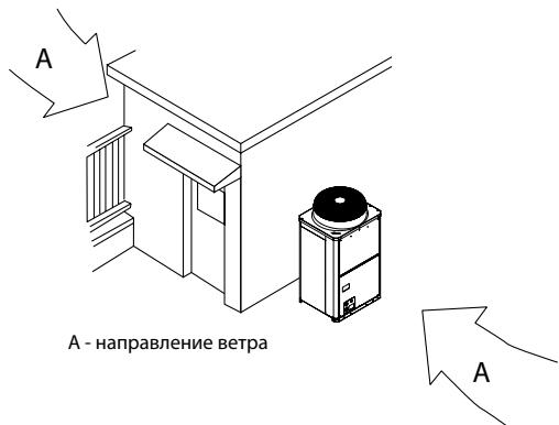
б) Выбирайте место для установки наружного блока, расположите его так, чтобы ветер преимущественного направления не воздействовал на теплообменник: расположите блок передней панелью к направлению ветра.
