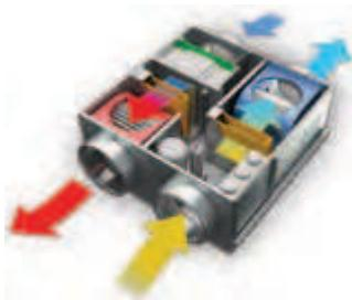
ELFOFresh<sup>2</sup> использует активную термодинамическую рекуперацию, при которой приточный и вытяжной воздух полностью разделены между собой. Теплопередача осуществляется через холодильный контур, без смешивания или контакта двух потоков.
